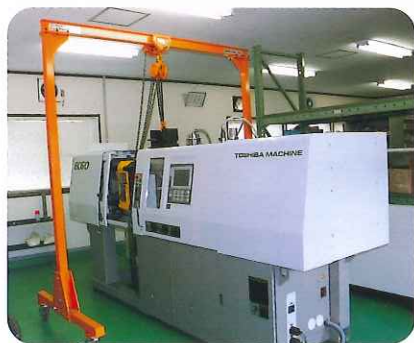
■成形機への金型取付け・取外し
